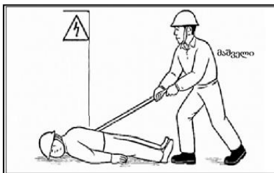
ნახ. 9.10. დაზარალებულის გათავისუფლება მაღალი ძაბვის ქსელში სპეციალური მტანგისა და მარწუხების გამოყენებით.
