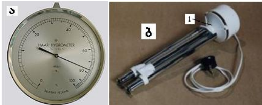
ფიგ. 3.8. ჰიგრომეტრი და ფსიქრომეტრი: ა - ჰიგრომეტრი; ბ - M-34M ტიპის ელექტროფსიქრომეტრი; 1 - ჩამოსაკიდებელი ჩანგლის დასამაგრებელი ადგილი.
