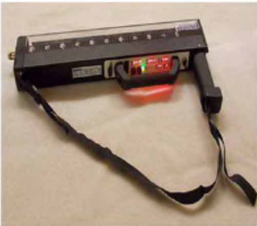
სურ.63, 64. ხის ხნოვანების, შემატებისა და ხის სადიანობის ხარისხის განმსაზღვრელი ელექტრო ხელსაწყო RESISTOGRAPH-445x
