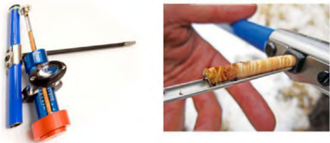
სურ.86, 87. ხის ხნოვანებისა და შემატების განმსაზღვრელი პრესლერის ბურღი გაუმჯობესებული
