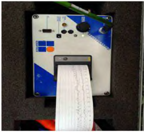
სურ.63, 64. ხის ხნოვანების, შემატებისა და ხის სადიანობის ხარისხის განმსაზღვრელი ელექტრო ხელსაწყო RESISTOGRAPH-445x
