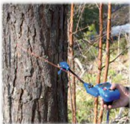
სურ.25.ლაზერული ტიპის შვედური ორთითა Digitech Pro One
