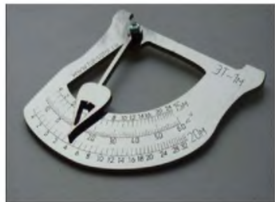
სურ.41. სიმაღლმზომი-ეკლიმეტრი ЭТ-1М
