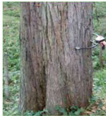
სურ. 24. სამუშაო პროცესი კომპიუტერული სატაქსაციო ორთითათი Masser Recal – 500 .
