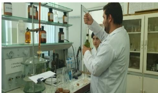
სურათი 71. საერთო გოგირდოვანი მჟავის განსაზღვრა ღვინოში
