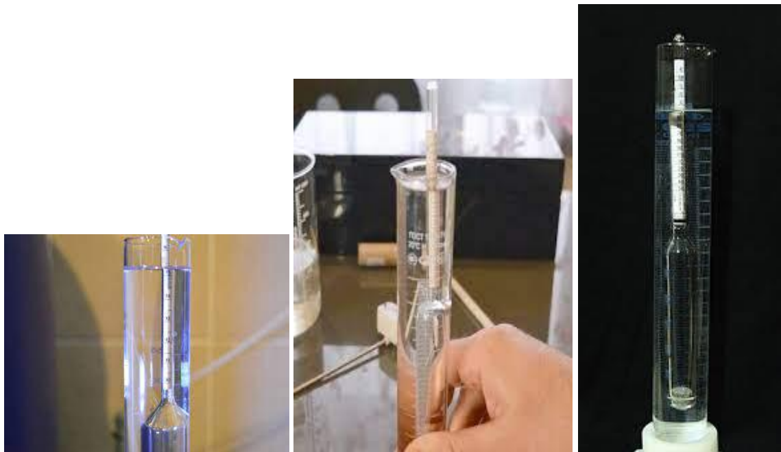
სურათი 54. საბრენდე სპირტის ნახადის სიმაგრის განსაზღვრა ჩაძირვის მეთოდით
