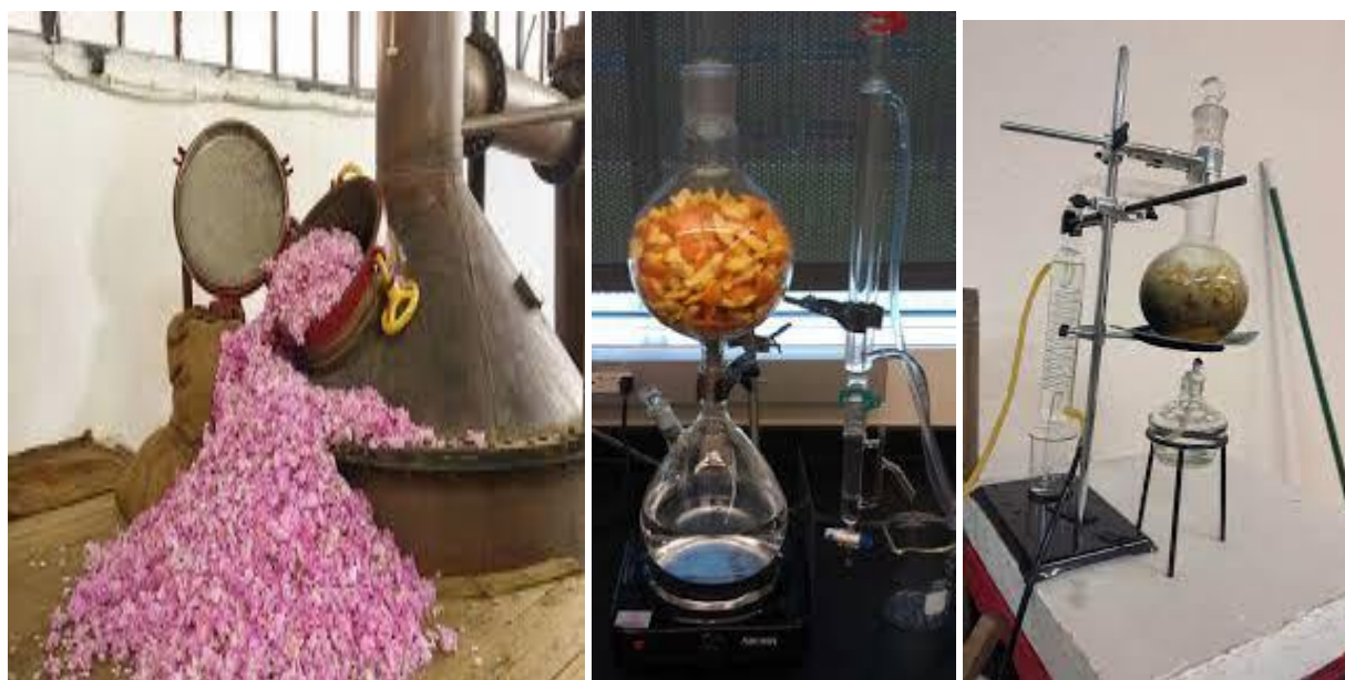
სურათი 44. ეთერზეთოვანი ნედლეულიდან ეთერზეთის გამოხდის მეთოდები
