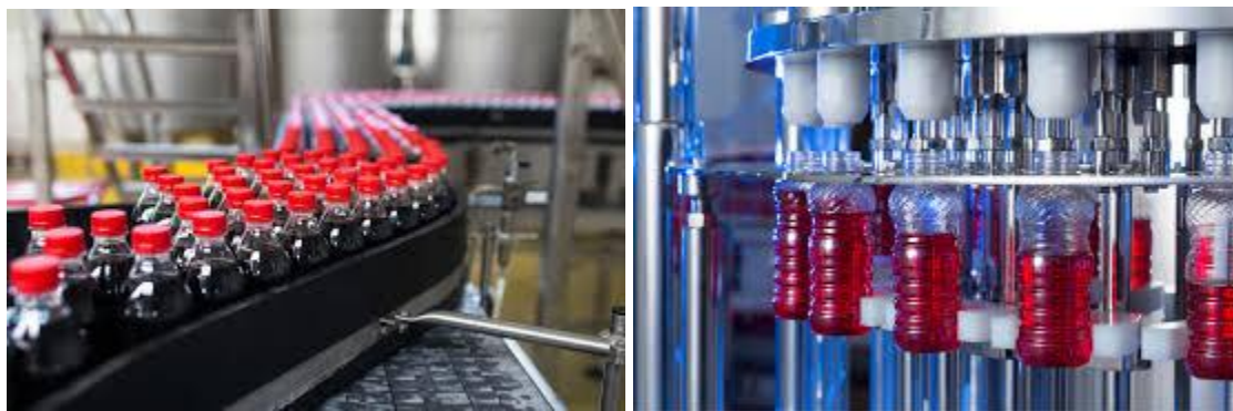
სურათი 93. უალკოჰოლო სასმელების ჩამოსხმა ბოთლებში
