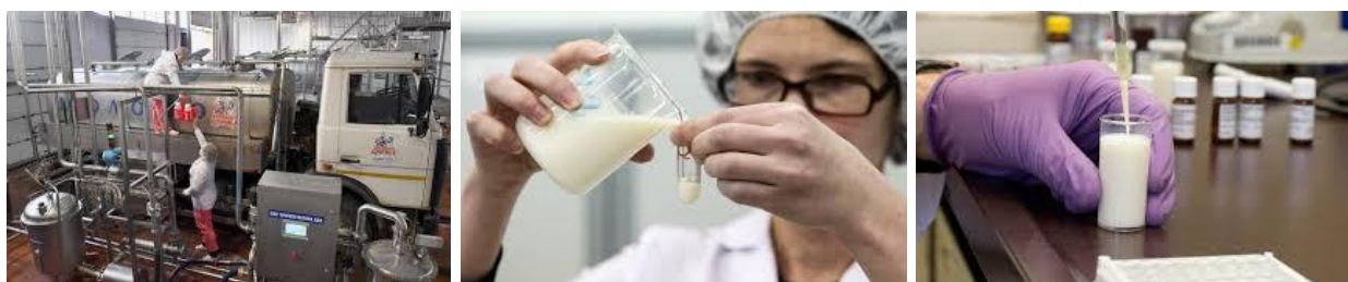
სურათი 5. რძის მიღება გადამამუშავებელ საწარმოში და სინჯების აღება ფიზიკურ-ქიმიური პარამეტრების განსაზღვრისთვის.
