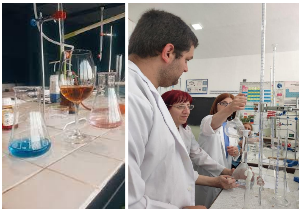
სურათი 69. ტიტრული მჟავიანობის განსაზღვრა ღვინოში
