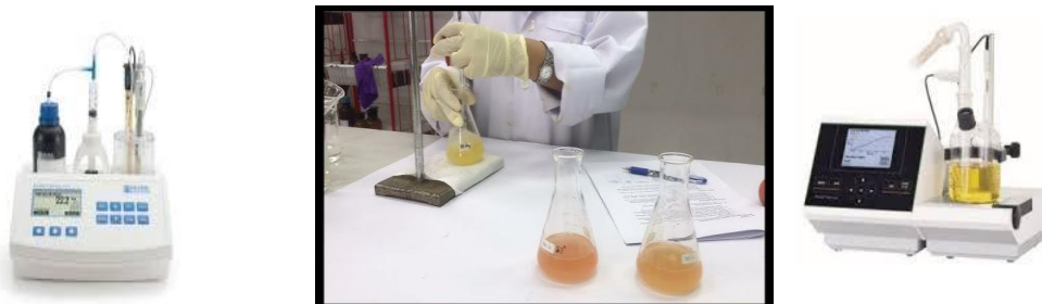
სურათი 19. ყველში მჟავიანობის განსაზღვრა ტიტრიმეტრული მეთოდით
