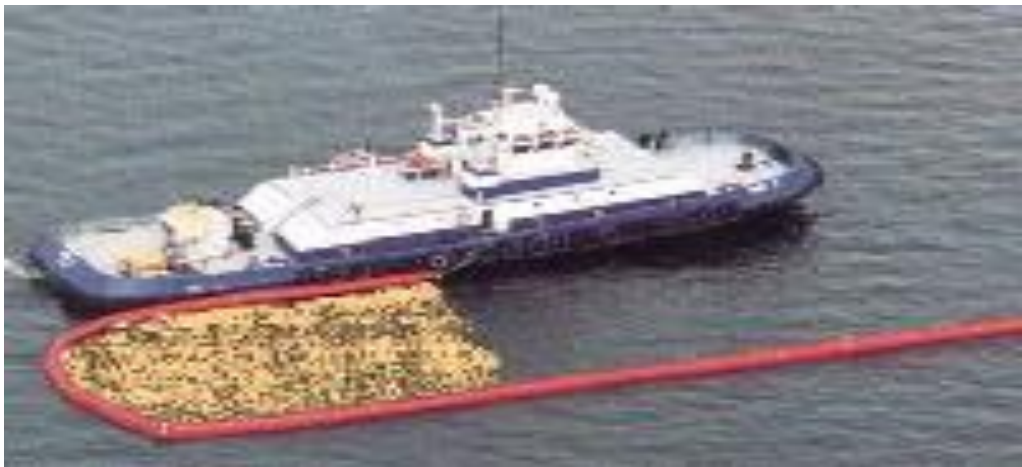
სურ. 5.4 სამრეწველო ბონურიზლუდის გამოყენება ზღვაში დაღვრილი ნავთობის ლოკალიზაციის მიზნით
