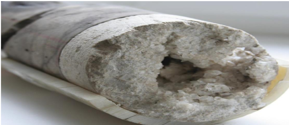
სურ. 6.12. სატუმბო-საკომპრესორო მილსადენში წარმოქმნილი მარილოვანი ნადები
