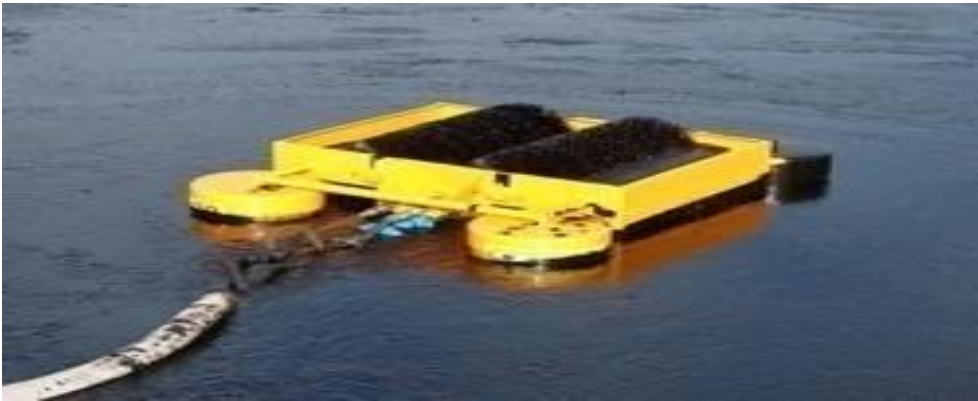
სურ. 5.6. ზღვაში დაღვრილი ნავთობის ამომღები მოწყობილობა ბათუმის საზღვაო ნავსადგურში.
