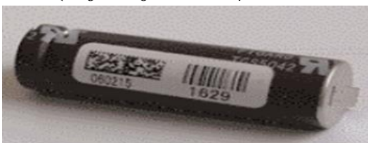
ნახ.3 თხევად ელექტროლიტზე დამზადებული ჟანგბადის სენსორი TGS5042 ტიპის
